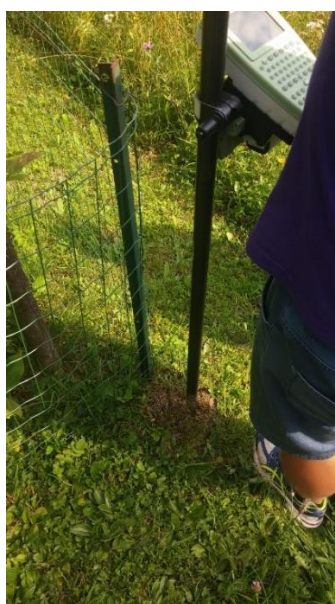
Slika 17: Izmera mejnika A z GNSS instrumentom (Vir: lastna fotografija).
