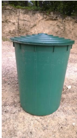
Slika 20: Plastičen sod (300 l) za namen drugega usedalnika (Foto: Jasmina Klančnik, 2016)
