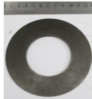
Figure 3 Disc spring DIN 2093-C112
