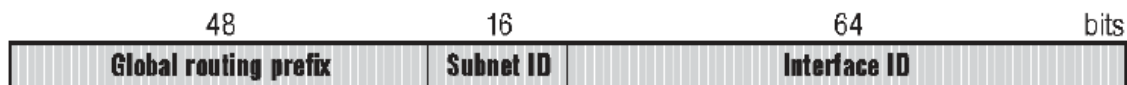
Фигура 1-11 Unicast IPv6 адрес с 16 битова подмрежа и 48 битов Global routing prefix
