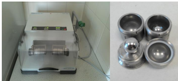
16. ábra A mechanokémiai szintézisekhez használt kétkarú rázómalom, valamint az acél őröltégelyek az őröltetekkel és golyókkal együtt.
