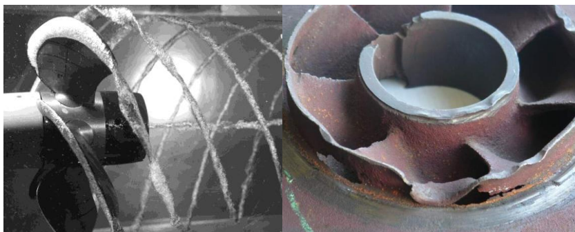
15. ábra Hajócsavar körül kialakuló kavitációs buborékok (bal ábra), és azok kártékony hatása egy elhasznált propeller darabon (jobb ábra).
