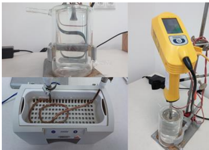
17. ábra Az alkalmazott ultrahangforrások és az ultrahangos közeg hőmérséklet-szabályozásának bemutatása.
