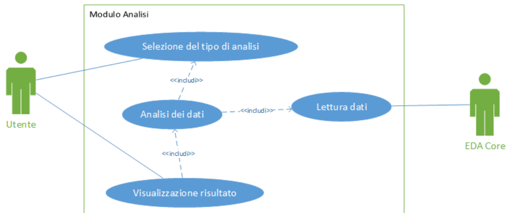
Figura 4.6: Diagramma UML dei casi d'uso del modulo di analisi
