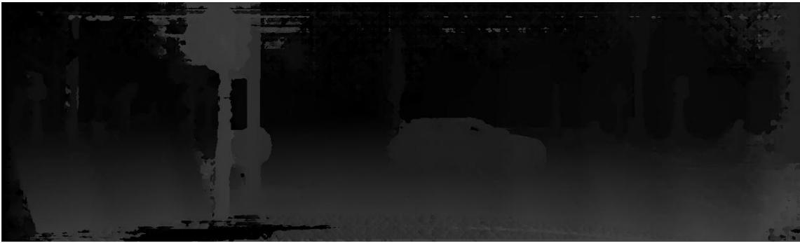
**Figura 4.6** Mappa di disparità ricavata dalle immagini *left-right* in figura 4.4. Il calcolo sulla qualità della disparità sarà valutato sull'area che viene fuori sovrapponendo, idealmente, la maschera di figura 4.5
