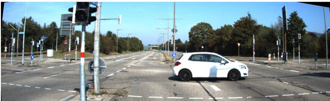
**Figura 4.3** Utilizzo di *lens4*: distorsione elevata, i pali sono decisamente curvati, specialmente nel bordo immagine. Il rosso del semaforo e i lampioni dietro l'auto non sono nemmeno rilevabili
