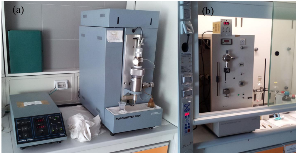
Figura III.15: (a) Unità micropori e (b) unità macropori del porosimetro ad intrusione di mercurio
