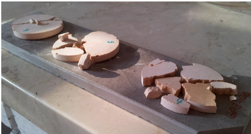
Figura IV.7: Campioni GP20 al termine della prova di assorbimento d'acqua sotto vuoto
