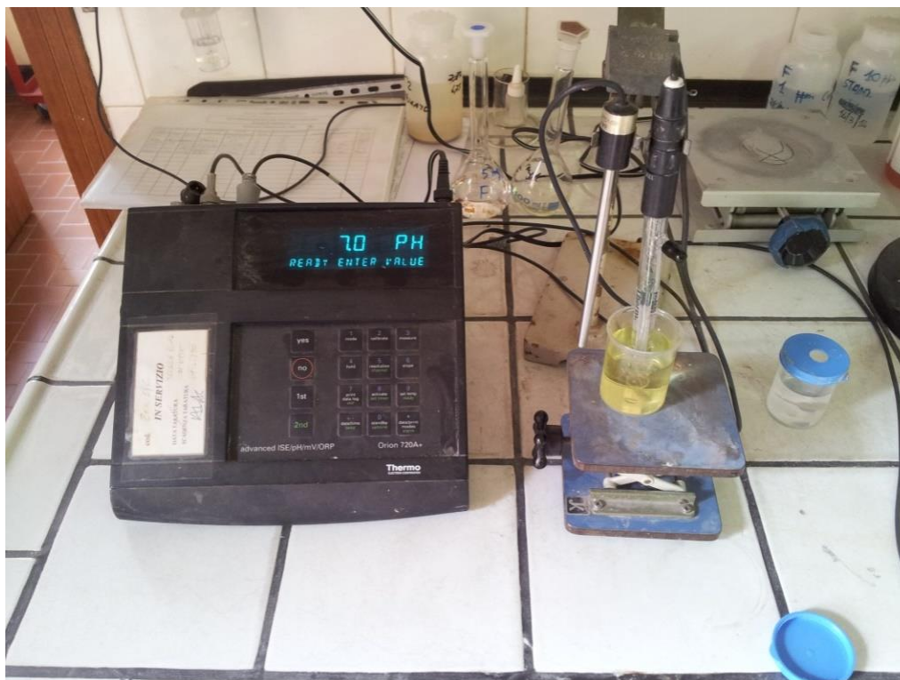
Figura III.14: Calibrazione del pHmetro
