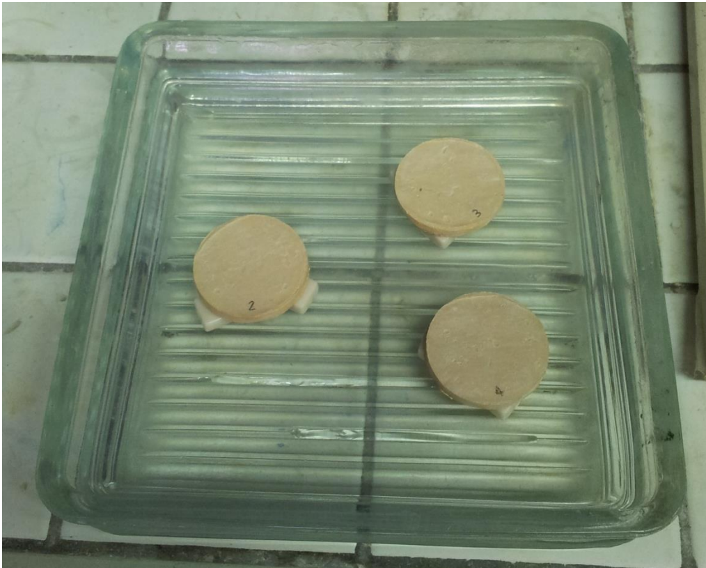
Figura III.12: Prova di assorbimento d'acqua per saturazione
