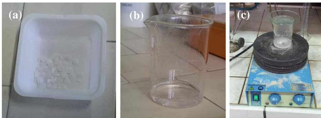
Figura III.5: (a) KOH in pellets, (b) silicato di Na e (c) agitatore magnetico utilizzato per facilitare la dissoluzione di KOH nel silicato di sodio
