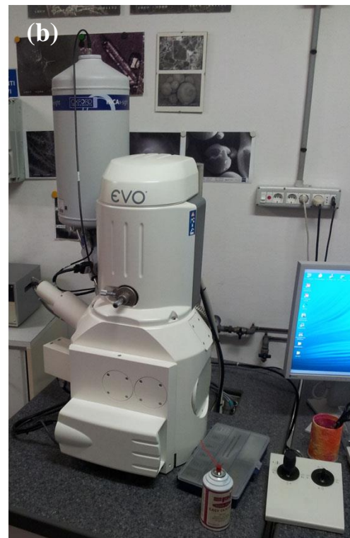
Figura III.17: (a) meccanismo di funzionamento del SEM e (b) microscopio elettronico Zeiss EVO 40 D
