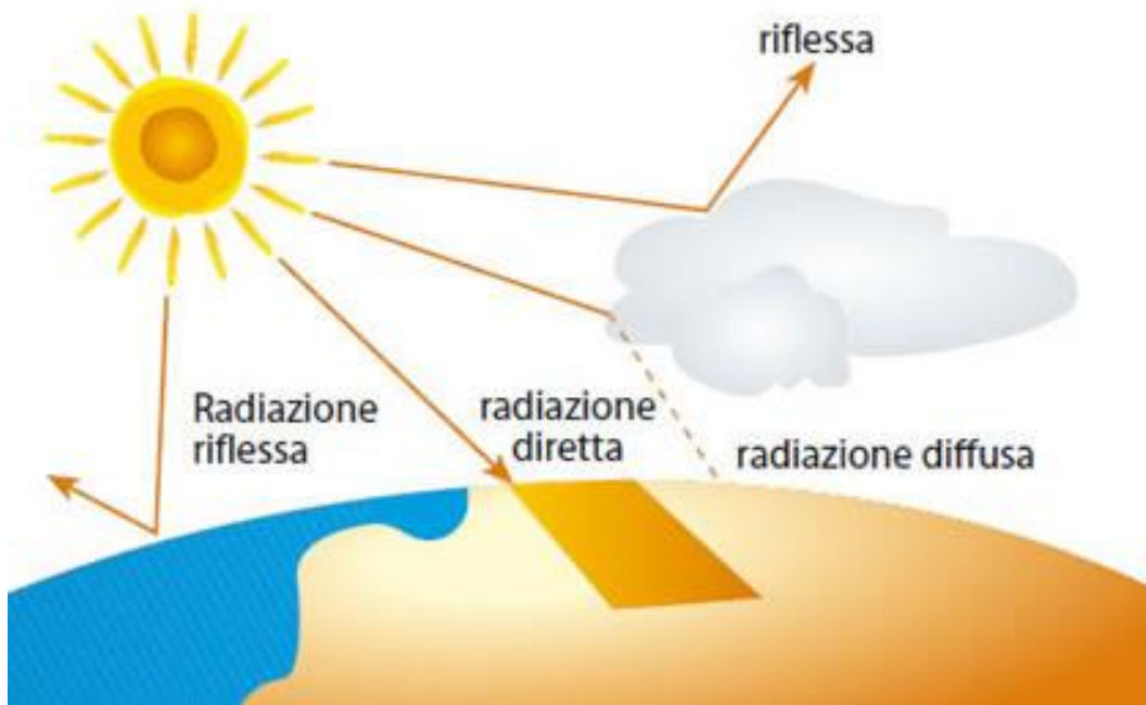
Figura 5: schema sulle varie parti che compongono la radiazione solare
