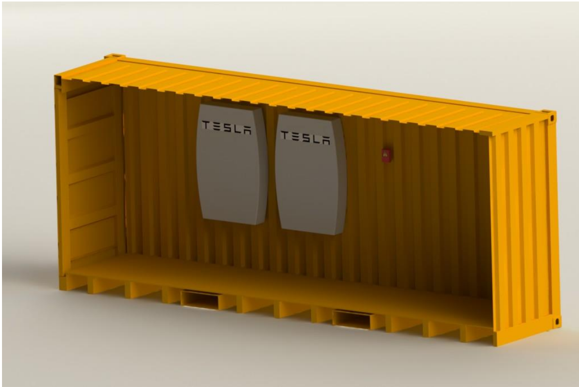
Figura 32: Utilizzo dello spazio interno
