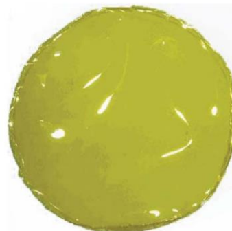
Figura 21. Film stabile di PIM-1 formato da una soluzione di THF.
