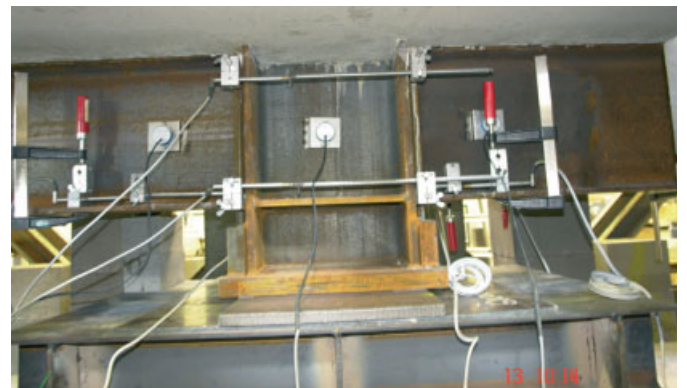
Bild 6. Anschluss der Versuchsreihe A, Wegaufnehmer und Inklinometer Fig. 6. Connection of test series A, displacement transducer and inclinometer
