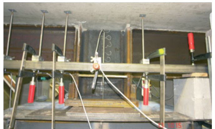
Bild 7. Anschluss der Versuchsreihe A, vertikal angeordnete Wegaufnehmer Fig. 7. Connection of test series A, vertical displacement transducer
