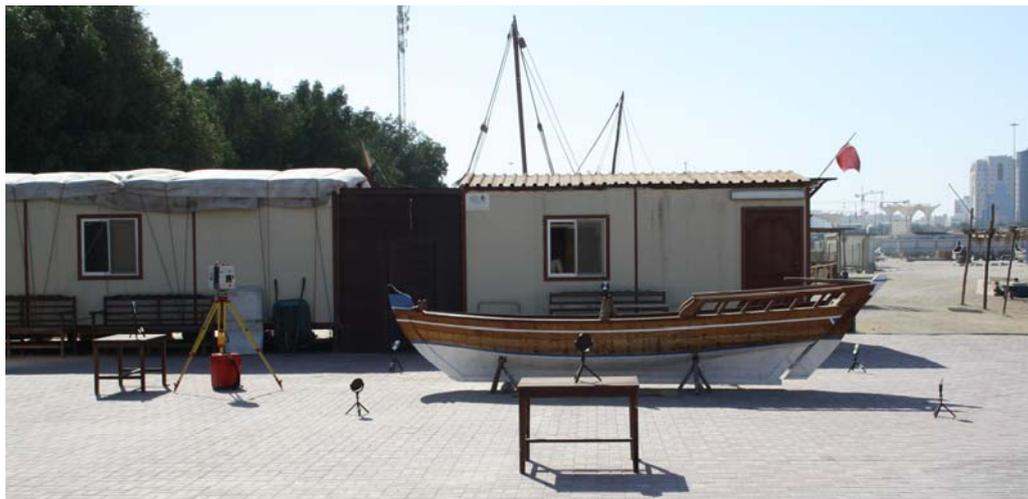
Fig. 1 - Scanner Laser 3D Leica HDS6000 con target grigio e nero intorno all'imbarcazione
