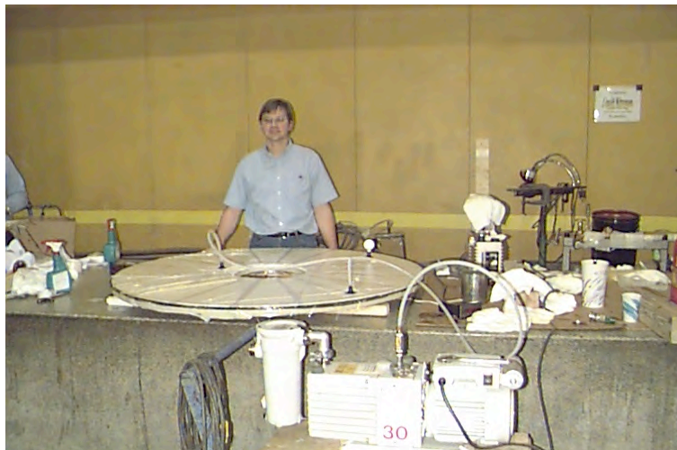
Fig. 16. Levitating coil for the LDX device, at MIT
