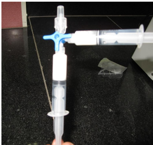
شکل ۳-۳- دستگاه سه‌راهی جهت مخلوط کردن باکترین با ادجوانت
