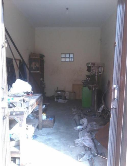
Gambar 3 merupakan gambar dari ruang 3 dari *workshop* utama. Ruang ini merupakan ruangan khusus untuk pemesinan dan penyimpanan alat dan bahan. Di ruang ini terdapat peralatan seperti mesin bubut, mesin bor duduk, mesin gerinda duduk, meja kerja, dan lemari peralatan.
