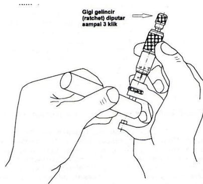
Gambar 5. Mikrometer untuk mengukur dimensi (luar) sampai dengan 25 mm
