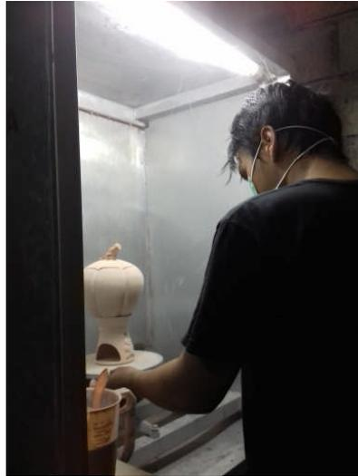
Gambar XIII: Proses pengglasiran dengan teknik semprot
