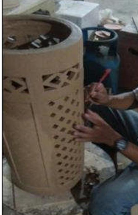
Gambar XI: **Proses dekorasi dengan teknik *pierching* atau terawang**
