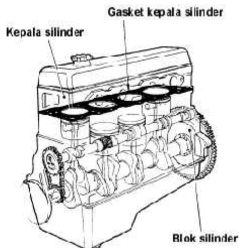
Gambar4. Penempatan paking kepala silinder
