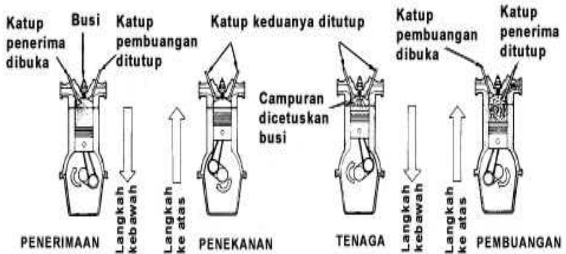
Gambar 13. Proses kerja mesin dengan pengapian busi (mesin bensin)
