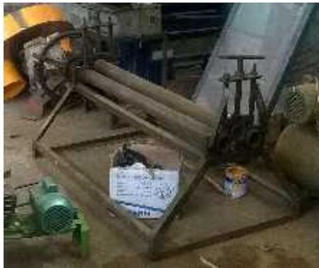
**Gambar 35. Mesin Roll Plat di CV. Tunas Karya**
