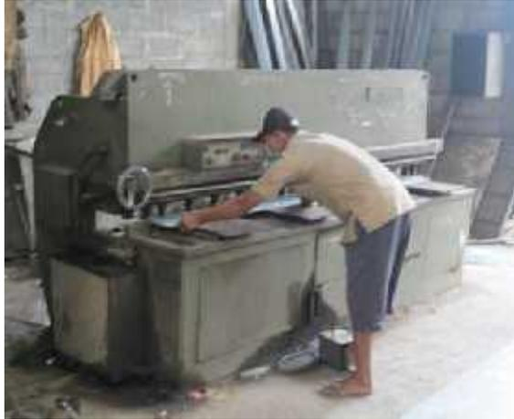
**Gambar 38. Mesin Potong Plat di CV. Tunas Karya**
