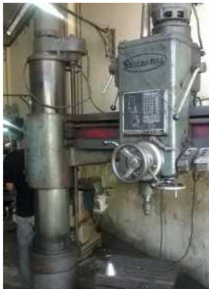
**Gambar 43. Mesin Bor Radial di PT. Dheawina Tekno**
