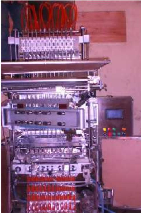
**Gambar 17. Multi Lines Packaging Machines untuk Saos**
