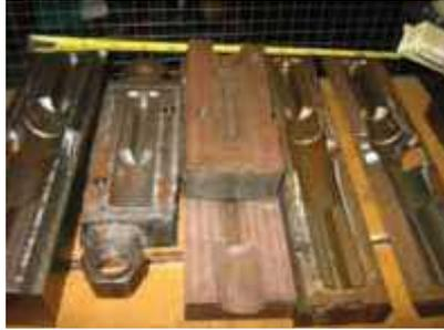
**Gambar 6. Mold (Cetakan) Produksi UPT Logam**
