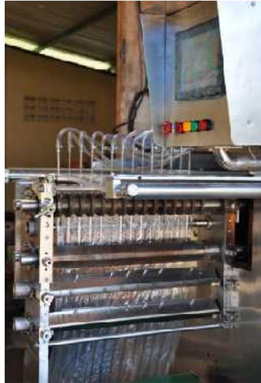
**Gambar 18. Multi Lines Packaging Machines untuk Bumbu Bubuk**
