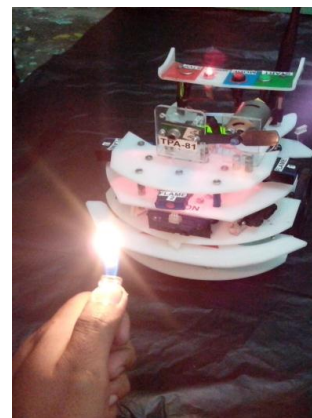
Gambar 32. Pengujian sensor uvtron dengan api
