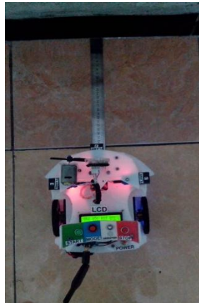
Gambar 29. Pengujian sensor jarak dengan penggaris
