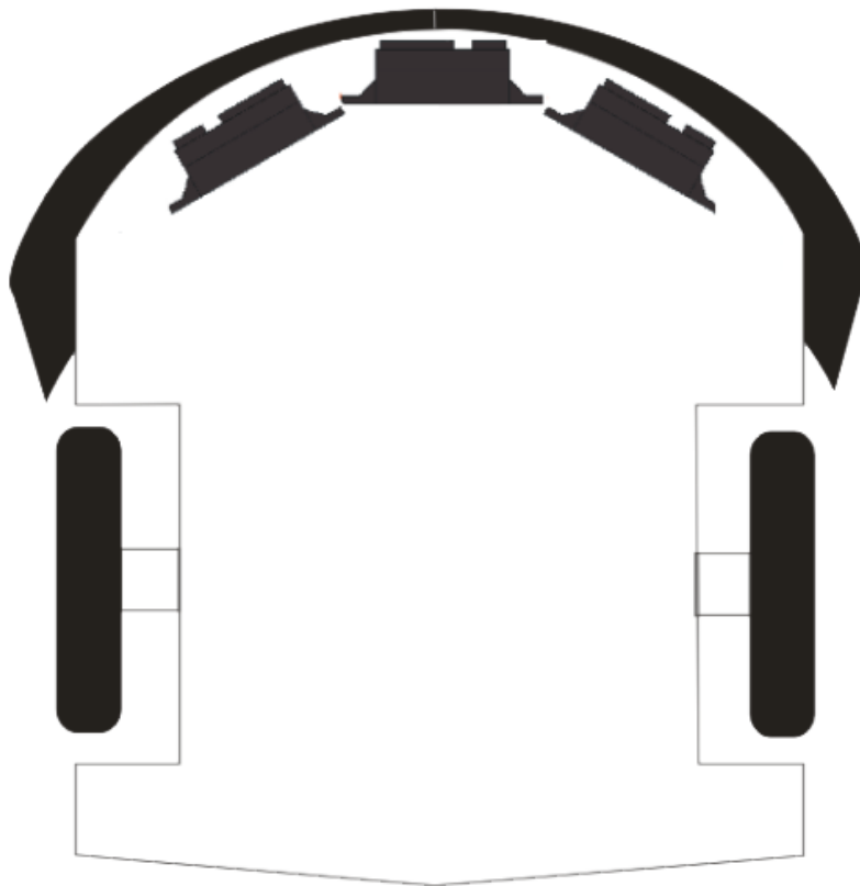
Gambar 21. Mekanik peletakan sensor sharp gp2d12
