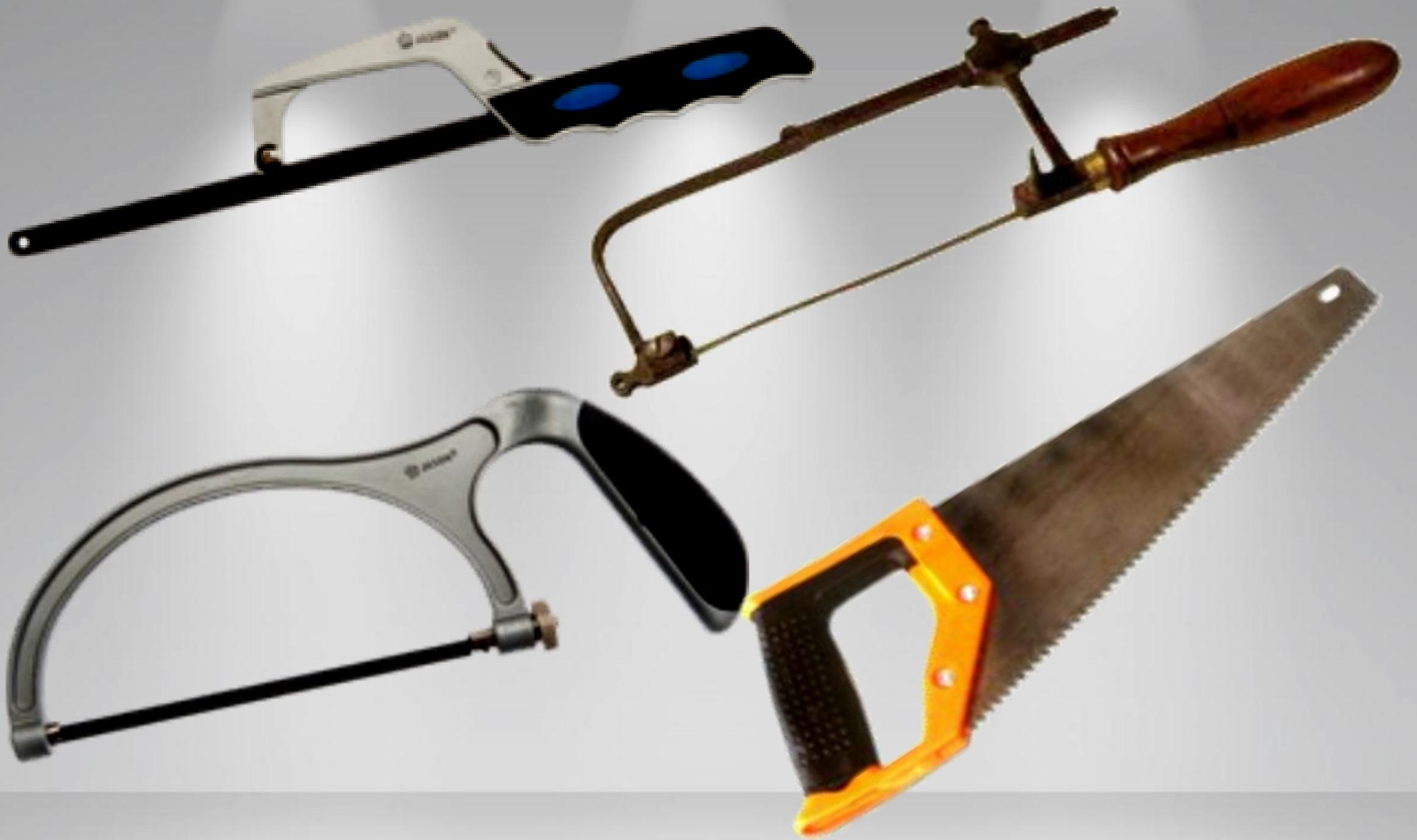
Letak gigi pemotong gergaji tangan ada yagn hanya satu sisi saja ( gigi tunggal = single cut) , ada pula yang pada kedua sisinya ( Gigi kembar = double cut).
