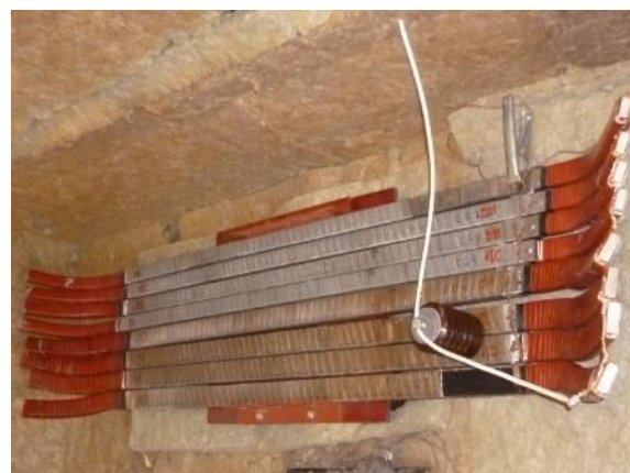
Figura 42. Barras de prueba del primer grupo utilizadas en el laboratorio de Alta Tensión de la Universidad KTH – Suecia.
