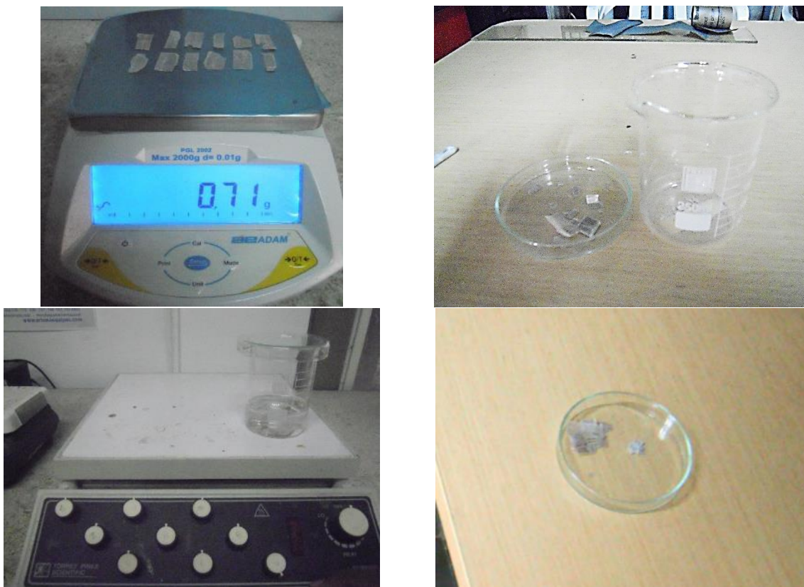
Figura 45. Método de remoción de las muestras del aislamiento disolviendo la resina en acetona.
