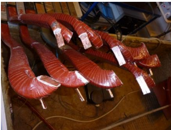
Figura 42. Barras de prueba del primer grupo utilizadas en el laboratorio de Alta Tensión de la Universidad KTH – Suecia.
