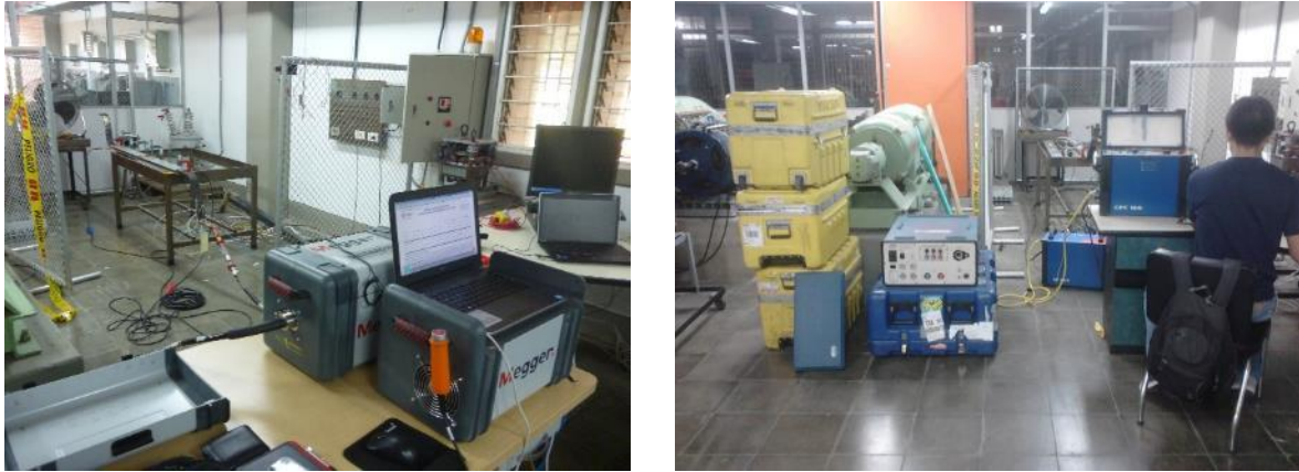
Figura 60. Equipos de medición de capacitancia y factor de disipación a 60Hz Doble M4100, Omicron TD1 y Megger Delta4000.
