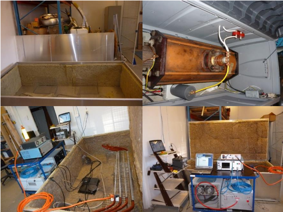
Figura 55. Implementación de un horno para aplicación de esfuerzos termoeléctricos (Universidad KTH-Suecia).
