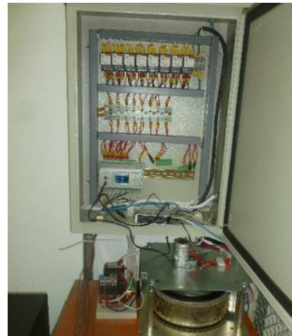
Figura 56. Sistemas de control del Laboratorio de Ensayo de Bobinas: a) Tablero principal de accionamiento y mando, b) Control de potencia independiente para cada barra sometida a esfuerzo térmico.
