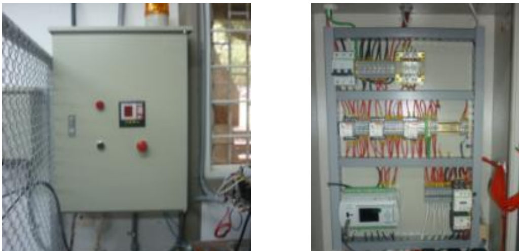
Figura 53. Sistemas de control y adquisición de temperaturas para la aplicación de esfuerzos termoeléctricos.
