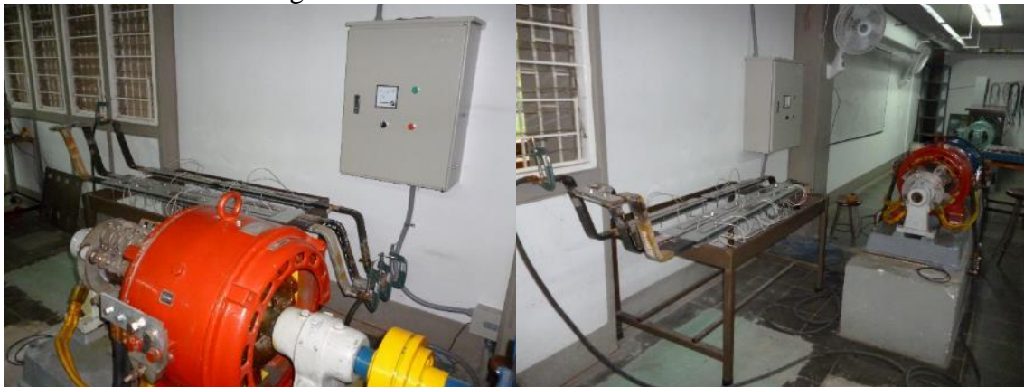
Figura 51. Implementación del banco para pruebas de ciclado térmico.
