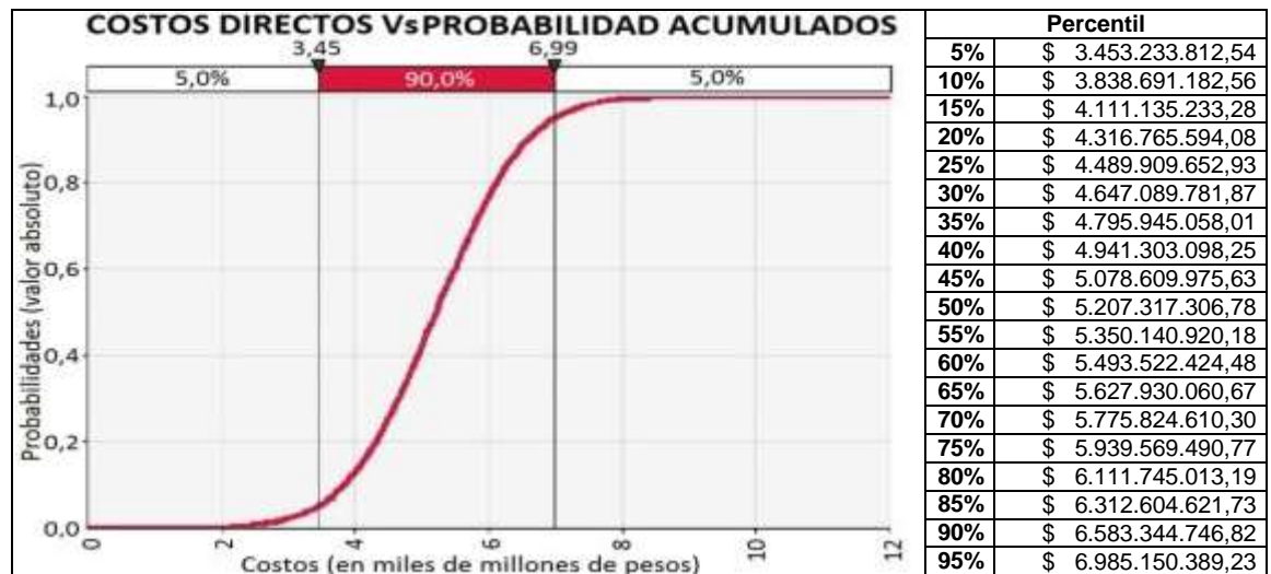
Figura No 11. Resultados de salida para el costo directo acumulada del proyecto vs probabilidad de ocurrencia.
