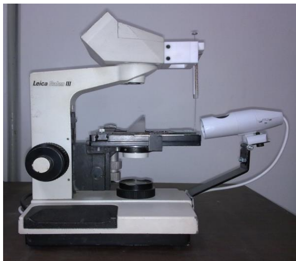
Figura 6. Goniómetro construido en el laboratorio de Separaciones Analíticas de la Universidad del Valle.
