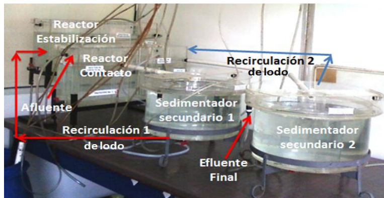
Figura 4.2. Configuración de la unidad experimental
