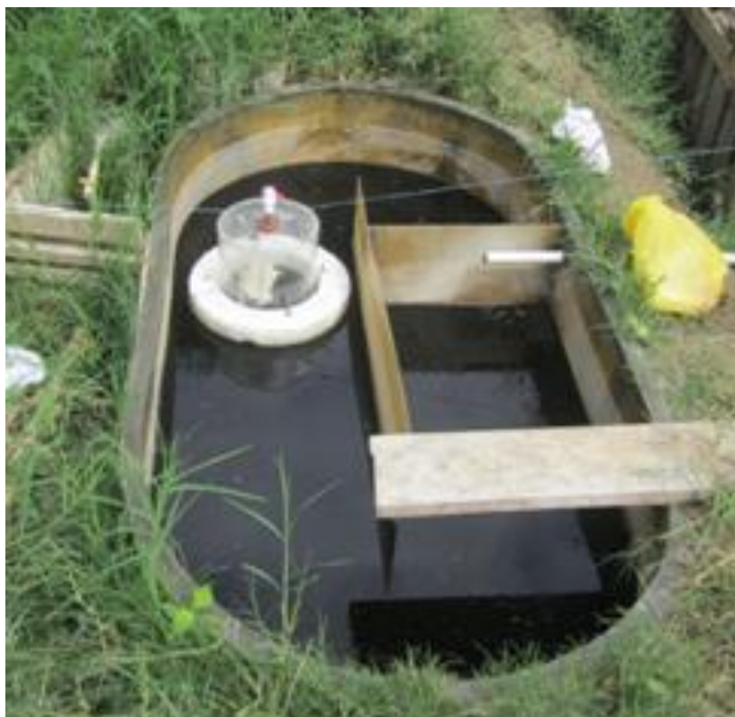
Figura 9. Medición de Flux, utilizando una cámara estática.
