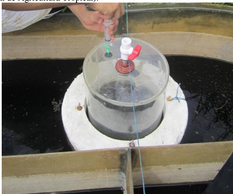
Figura 10. Toma de muestra de Gas en la cámara estática.
