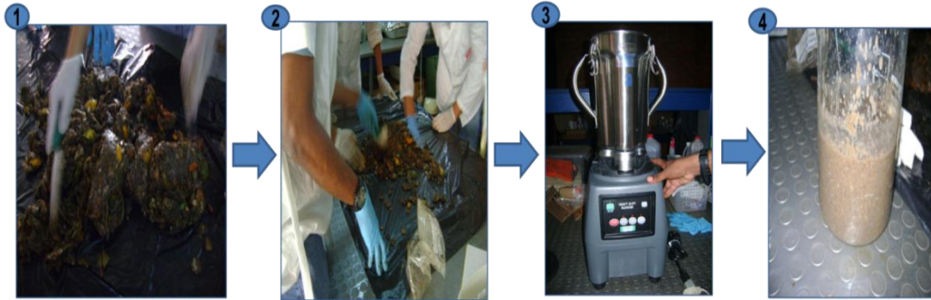
Figura 4.3 Pretratamiento del BOM a digestado
