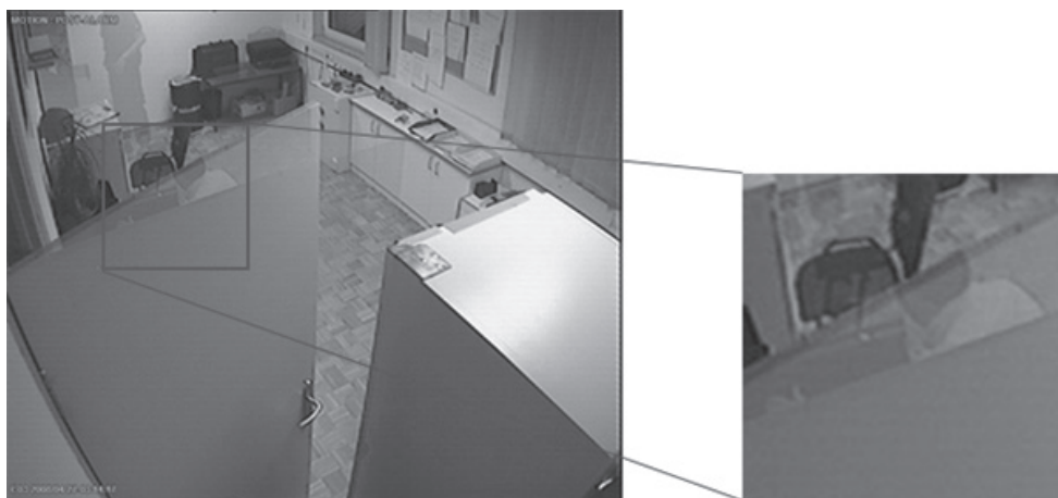
Slika 5: Primer neprimerno postavljene nadzorne kamere, kjer vrata zakrijejo velik del prostora, vključno s trezorjem, ki je najpomembnejši predmet v prostoru s stališča varovanja.
