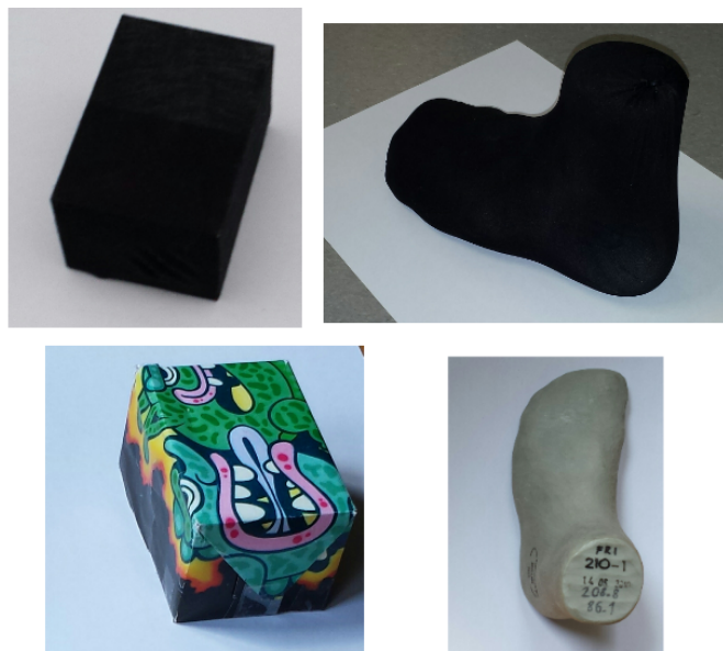
Slika 7.11: Črna predmeta na zgornjem delu slike se uporabljata pri metodi prostorskega klesanja, predmeta na spodnjem delu slike pa pri metodi stereo vid.
