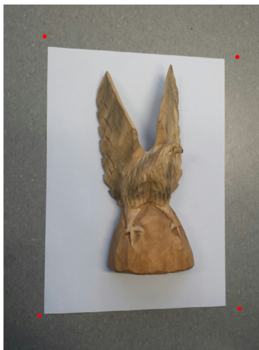
Slika 3.1: Primer vhodne slike z označenimi rdečimi točkami referenčnega okvirja. Objekt rekonstrukcije je situiran znotraj lista formata A4.
