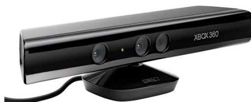
Slika 2.2: Barvno-globinska kamera Microsoft Kinect.
