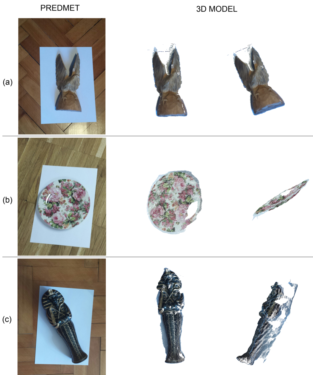
Slika 7.21: Primeri rekonstrukcij z metodo Stereo vid . (a) primer rekonstrukcije lesenega orla. (b) primer rekonstrukcije krožnika. (c) primer rekonstrukcije sarkofaga.
