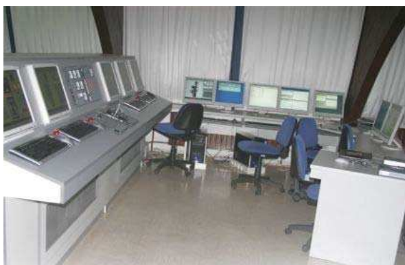
»Full Scope« Transas ERS 4000 konzola ladijske strojnice in »Workstation« Kongsberg-Norcontrol ver. 2005 izvedba ladijske strojnice
