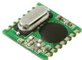
Slika 3.2: Modul za brezžično komunikacijo ALPHA-TRX433S
