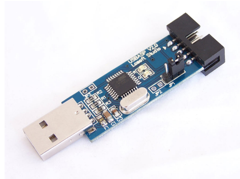
Slika 2.2: Programator USBasp. Vir [3].
