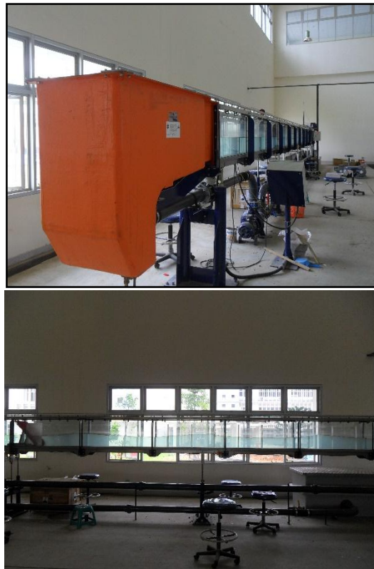
Gambar 3.1 Tangki Pembangkit Gelombang ( Wave Flume )
