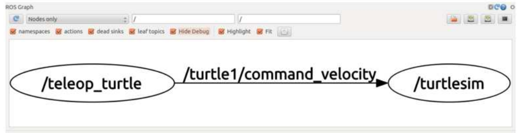
Figure 54: Communication entre deux nœuds via le Topic command_velocity .
