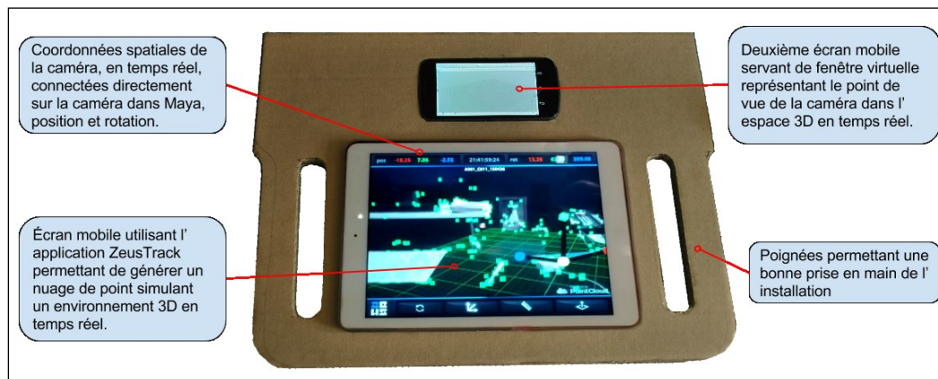
Figure 22 : Prototype de caméra virtuelle, exemplaire fabriqué par Fabrice Vienne le 27 avril 2015.
