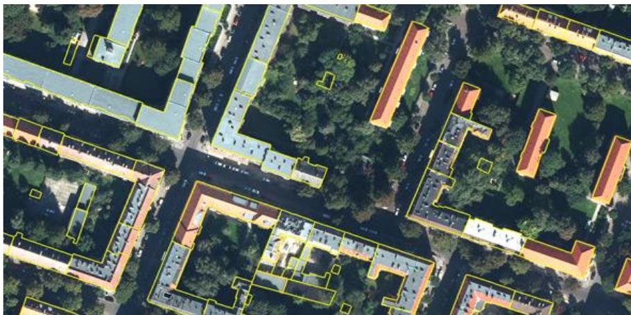
Abb. 26 Ergebnis der Chessboard Segmentation unter Verwendung des ALK Layers (gelbe Linien)
