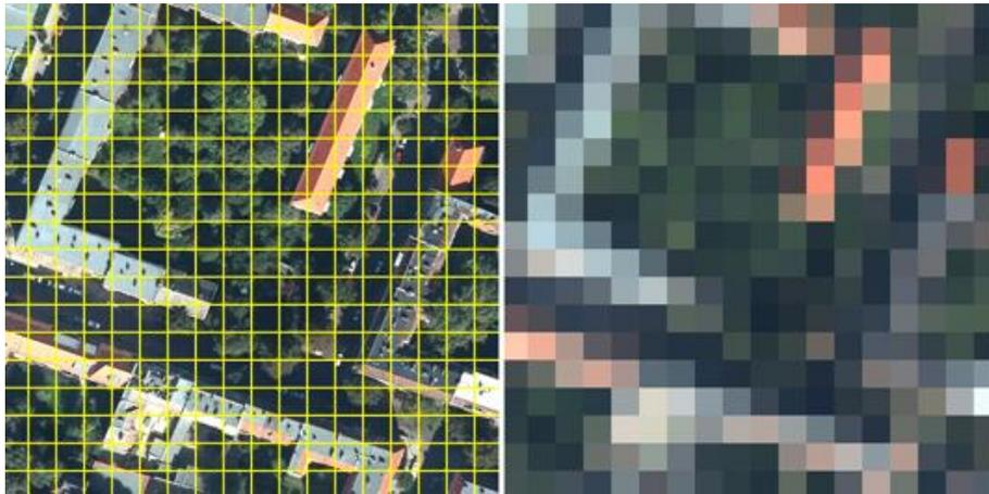
Abb. 25 Chessboard Segmentation mit einer Schachbrettgröße von 30 x 30 Pixeln
