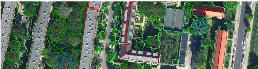
Abb. 52 Ergebnis der bedingten Image Object Fusion: kleine Objekte werden mit den angrenzenden Dachteilsegmenten verschmolzen
