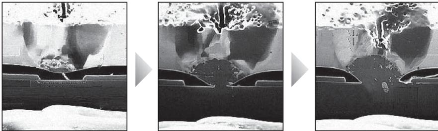
**CoolMos-Technologie, die nicht strahlungsgehärtet ist, übersteht kosmische Strahlung nicht. Die Bilderreihe zeigt ein SEE Fehler von nicht strahlungsresistenter Infineon CoolMos-Technologie.**
