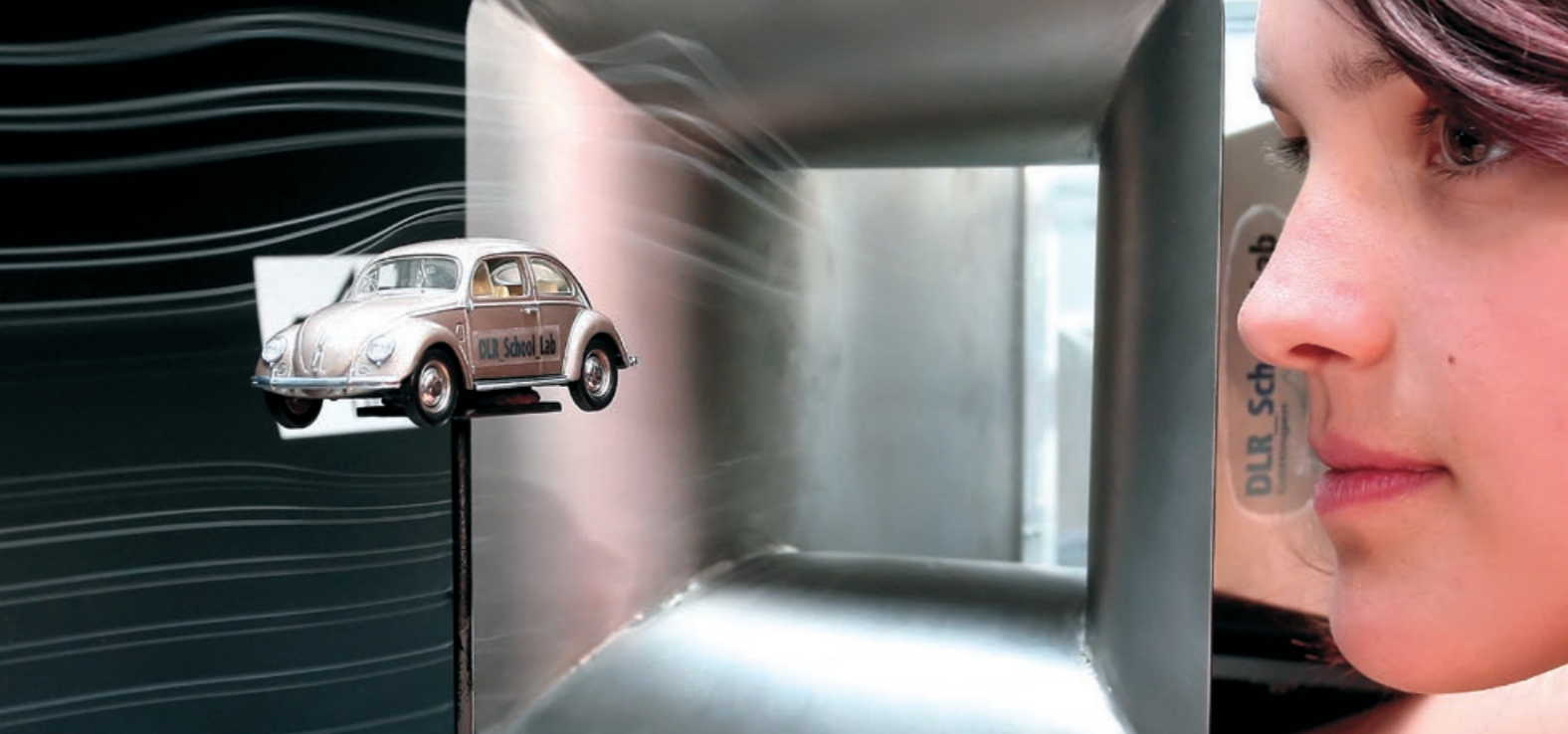
Unsichtbares sichtbar gemacht: Windkanäle zeigen, wie Objekte umströmt werden. Das Bild aus dem DLR_School_Lab Göttingen veranschaulicht das.
