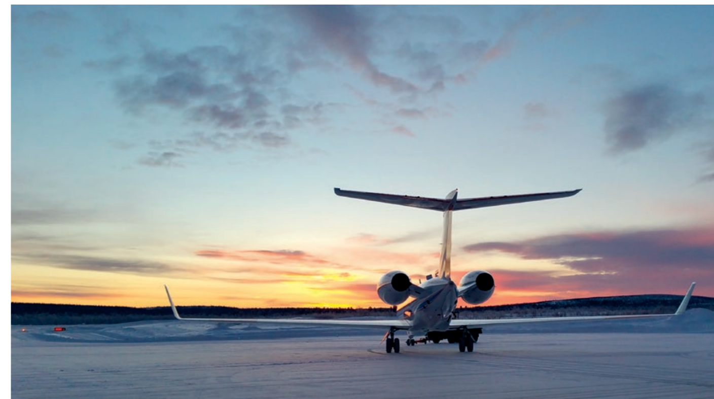
HALO kurz vor dem Start: Das Atmosphärenforschungsflugzeug basiert auf einem Ultra Long Range Business Jet G 550 der Firma Gulfstream. Die Kombination aus großer Reichweite, Flughöhe, Nutzlast und umfangreicher Instrumentierung macht das Flugzeug zu einer weltweit einzigartigen Forschungsplattform.
