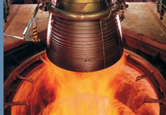
Vulcain 2-Triebwerk während eines Tests am DLR-Prüfstand P5
