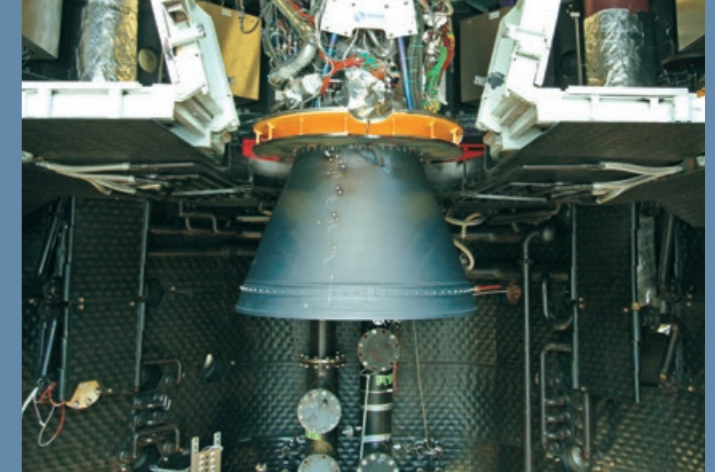
Vinci®-Triebwerk am DLR-Prüfstand P4.1
