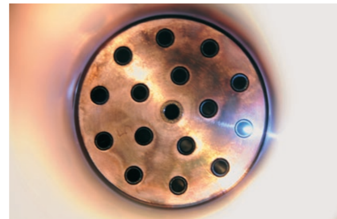
Blick durch die Düse der Brennkammer auf die Einspritzelemente des Injektorkopfs mit dem mehrere tausend Grad heißen Plasma, erzeugt durch den Laserpuls
