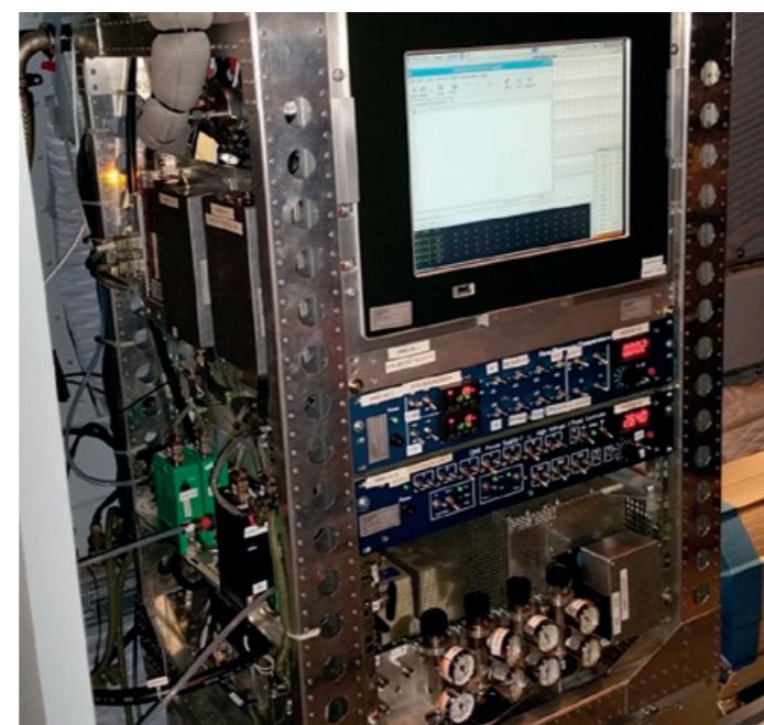
Massenspektrometer AIMS: Um die in der Atmosphäre ablaufenden Prozesse besser zu verstehen, ist es wichtig, dort vorhandene Partikel zu charakterisieren. Dazu muss deren chemische Zusammensetzung bestimmt werden. Mit dem Aerosol-Ionenfallen-Massenspektrometer (AIMS) können die Wissenschaftler organische Partikel analysieren.
