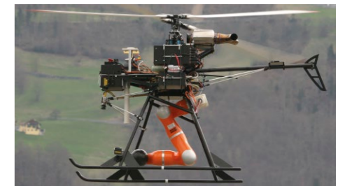
Autonomer Flettner-Hubschrauber mit integriertem robotischen Arm
