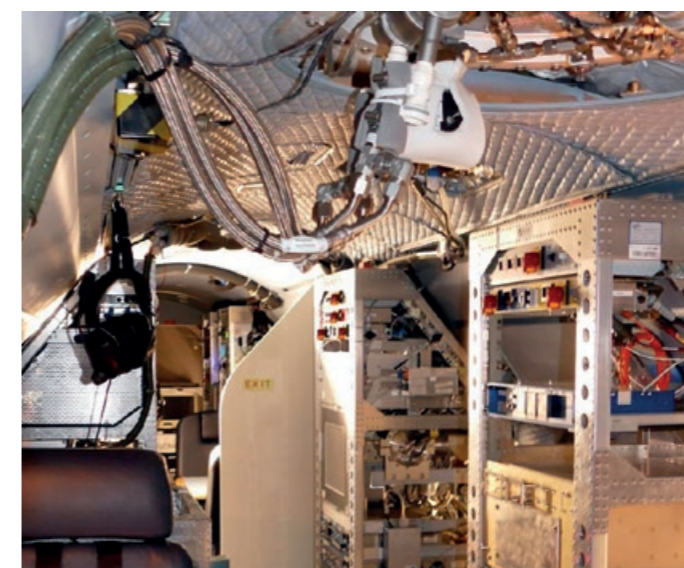
Der Innenraum von HALO: Bis zu 15 Racks für wissenschaftliche Messgeräte passen in die Kabine. Vorne rechts: zwei Messinstrumente zur Bestimmung der Luftfeuchtigkeit (Hygrometer) und ein Ozongerät. Im Hintergrund sieht man das atmosphärische Massenspektrometer AIMS (Aerosol-Ionenfallen-Massenspektrometer). Es misst Halogen- und Stickoxidverbindungen, die den polaren Ozonabbau fördern.
