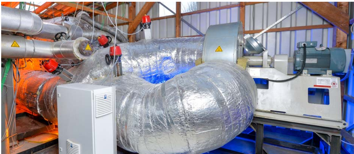
Abb. 4.6: Oben: Außenansicht der Versuchsanlage mit der Behausung (links) und dem Regenerator (rechts). Unten: Innenansicht der Versuchsanlage, rechts der Radialventilator und im linken Teil die Klappkastengruppe sowie der Wärmeübertrager im Hintergrund
