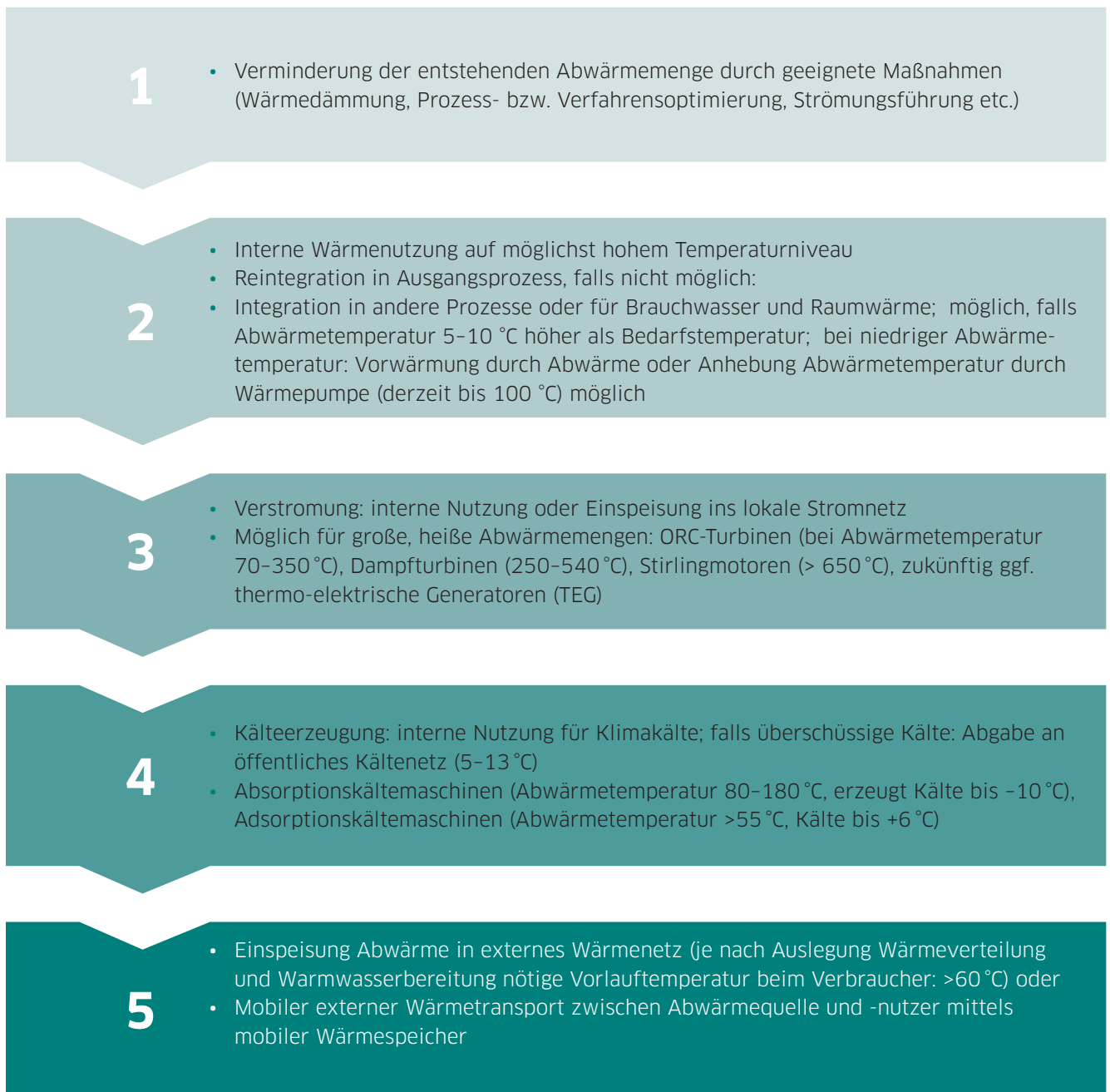
Abbildung 11-5: Rangfolge eines technisch und wirtschaftlich effektiven Umgangs mit Abwärme und entsprechende Nutzungstechnologien
