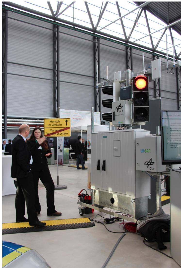
Abbildung 10: UR:BAN Halzeitpräsentation: Car2X-Laboranlage versorgt Partnerfahrzeuge mit Car2X Nachrichten. Mit dieser LSA wurden auch Sende- und Empfangstests sowie Tests der Einsatzfahrzeug-Priorisierung durchgeführt.
