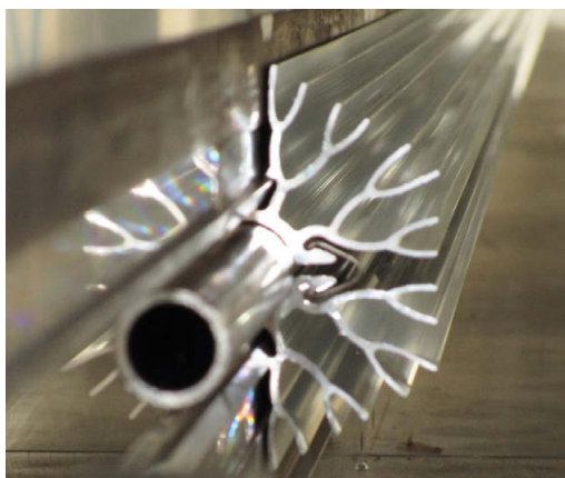
Abbildung 3 Beripptes Rohr für den Testspeicher
