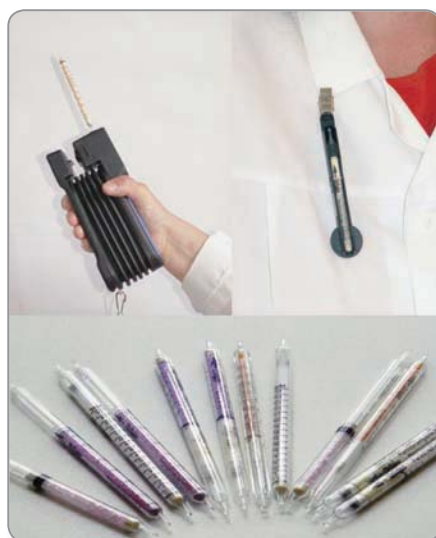
Figure D.6: Système de mesure des gaz et vapeurs dans l'air par tubes colorimétriques. Pompes et tubes pour mesures instantanées, tubes passifs pour la mesure intégrée dans le temps.
