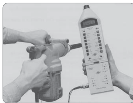
Figure D.17: Exemple d'une mesure de vibration sur un marteau pneumatique
