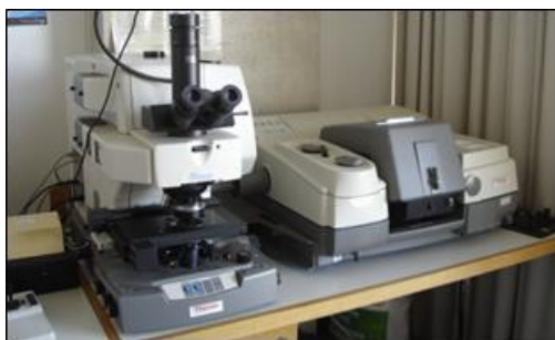
Figure 3.10 : Spectromètre FTIR Thermo-Fisher à disposition à l'institut de police scientifique, Université de Lausanne.
