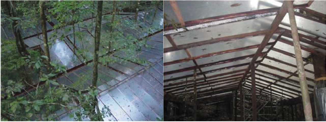
FIGUR 2. Det storskaliga experimentet i Caxiuaná, nord-östra Brasilien, där torka simulerats. Vatten dräneras från plastpaneler (uppifrån, t.v., och underifrån, t.h.) under regnfall och förs bort från experimentområdet via kanaler. Foto Antonio Carlos Lola da Costa.
