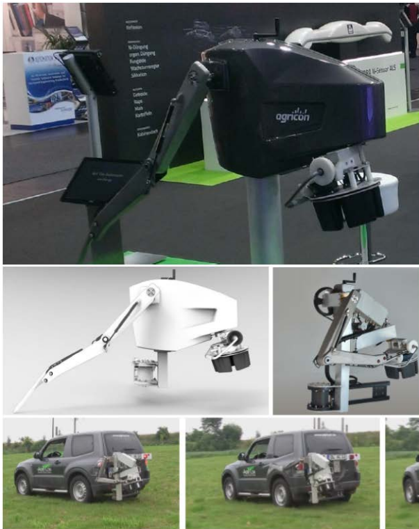
Figur 1. Innovativ jordprøvetager utviklet og patentert av det norske firmaet Adigo AS. Jordprøven tas i fart, og bruker bilens bevegelsesenergi til å trykke jordspydet i bakken. Illustrasjon: Øyvind Overskeid
