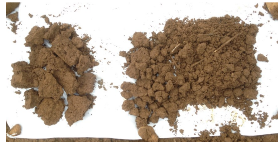
Figure 12: Répartition des horizons sur la bêche et classement des mottes: ici deux horizons sont séparés et caractérisés séparément
