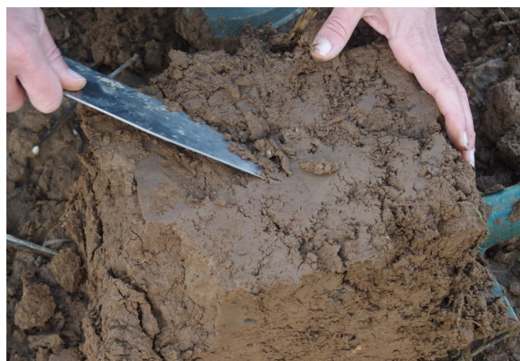
Figure 10: Rafraîchissement du bloc à l'aide du couteau
