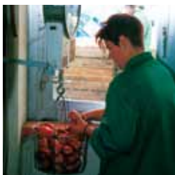
Der Stärkegehalt wird aus dem Unterwassergewicht errechnet.
