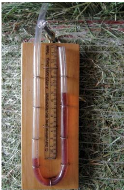
Abb. 6: Ein U-Rohr-Manometer hilft bei der Überwachung der Anlage (Wirleitner 2016)
