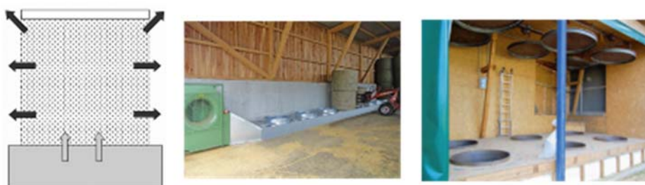
Abb. 8: Untenbelüftung: Luftstrom im Ballen und Beispiele für Anlagen (Holpp 2004, Firmenbild www.lasco.at/rundballentrocknung 2015, Wirleitner 2016)
