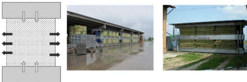
Abb. 10: Oben- und Untenbelüftung: Luftstrom im Ballen (links), Beispielanlage für Rundballentrocknung (mitte) und Quaderballentrocknung (rechts) (Holpp 2004, Firmenbilder www.climair50.com 2016)
