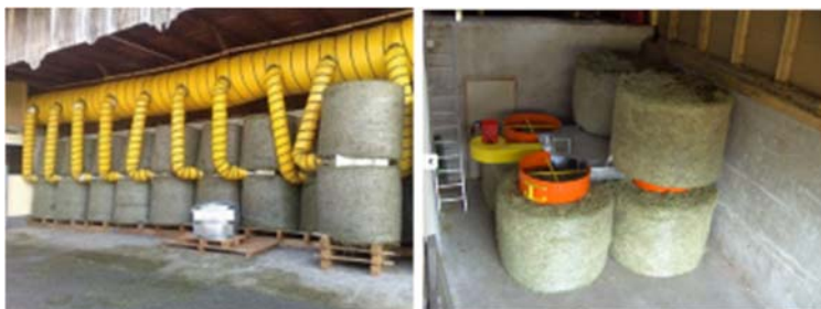
Abb. 9: Rundballentrocknung mit flexiblen Zwischenringen (einzeln) (links) und als Kompaktanlage (rechts) (Firmenbilder www.lasco.at/rundballentrocknung 2016, www.2015.rmh.at/rmh-rundballenbelueftung 2016)
