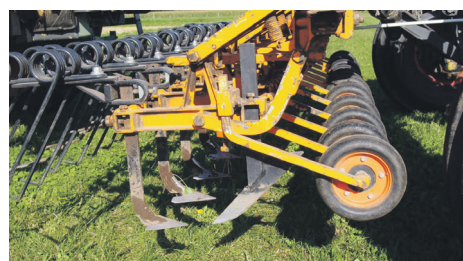
Modificeret Schmotzer radrenser, udviklet af Aarhus Universitet – Institut for Agroøkologi. Der er monteret en kniv foran renseskærene for at minimere slæbningseffekten fra afgrøderesterne.
