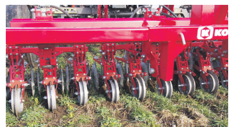
AGROINTELLI's nyudviklede rensesektioner, hvor der er udviklet og fremstillet et dybdehjul til forskæring af afgrøderesterne således de ikke slæber - Den viste løsning fra AGROINTELLI er Designbeskyttet.
