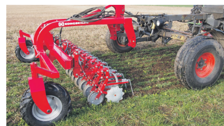
AGROINTELLI's nyudviklede rensesektioner, hvor der er udviklet og fremstillet et dybdehjul til forskæring af afgrøderesterne således de ikke slæber - Den viste løsning fra AGROINTELLI er Designbeskyttet.
