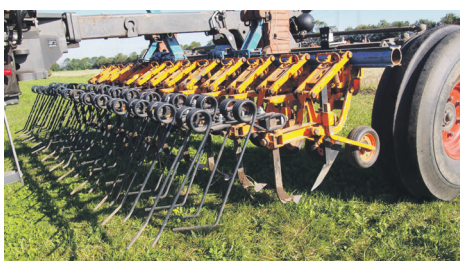
Modificeret Schmotzer radrenser, udviklet af Aarhus Universitet – Institut for Agroøkologi. Der er monteret en kniv foran renseskærene for at minimere slæbningseffekten fra afgrøderesterne.
